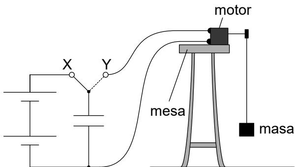
Cuando el conmutador se conecta en X, el capacitor se carga usando la batería. Cuando el conmutador se conecta en Y, el capacitor se descarga totalmente a través del motor eléctrico, que eleva una pequeña masa.
