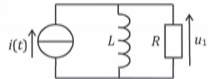
Figure 7 : circuit de filtrage du signal recueilli
