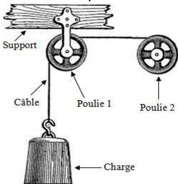
Pendant la montée de la charge (poutre, récipient ou panneau préfabriqué), le câble s'enroule autour de la gorge de la poulie 2 fixée sur l'arbre (axe) d'un moteur.
